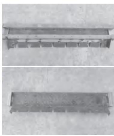
图7 加工成型的梳形挡板
