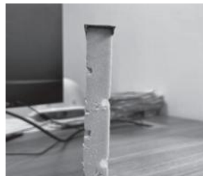
分隔缝嵌塑料线条设置图
